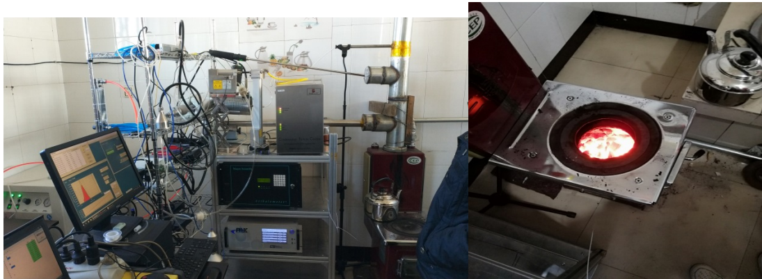
图 1 民用煤燃烧模拟测试系统
